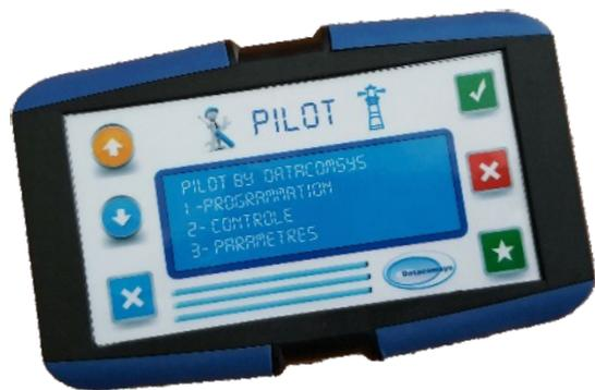
Le module PILOT permet de paramétrer, configurer et de vérifier le bon fonctionnement des modules ATRIA.
