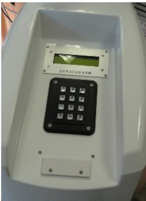
Des TOTEM ont été utilisés dans des applications spécifiques de distribution d'eau en Polynésie Française, pour profiter de l'interface clavier / afficheur et d'une programmation spéciale (Distribution d'eau par badge RFID).
