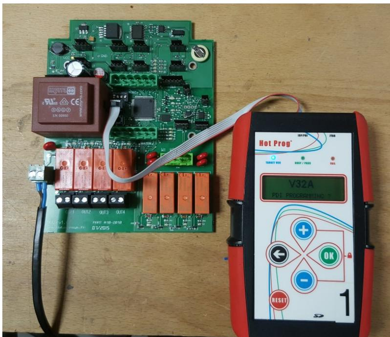
Le programmeur doit être branché la **centrale sous tension.**
