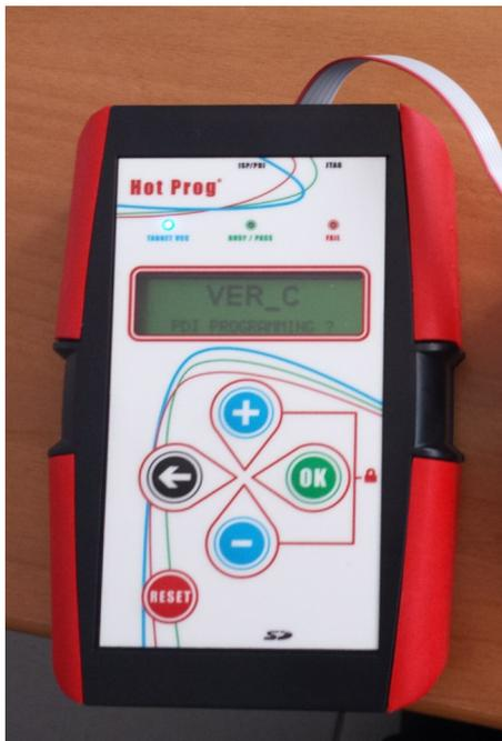
HOT-PROG est un boîtier autonome, avec un afficheur LCD pour informer de son état, un clavier 4 touches pour l'utiliser et un câble de liaison qui se branche directement sur la centrale à programmer.
