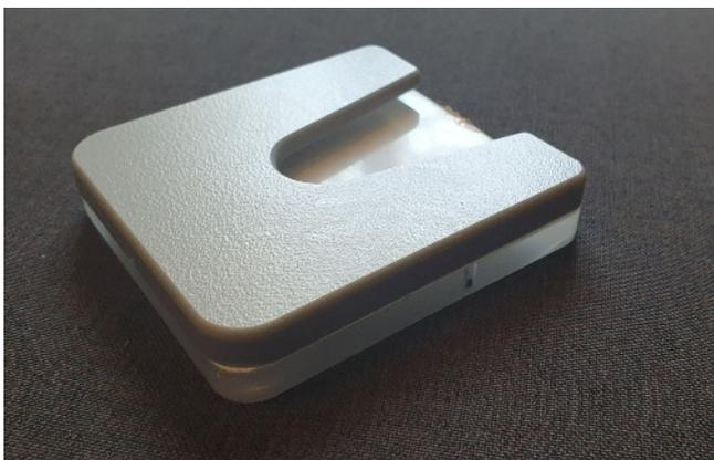
Le GODET PLAT intégrant un lecteur RFID, est un ensemble mécanique composé d'un support ABS permettant l'introduction du badge RFID et d'un module électronique inséré dans un bloc de plexiglas. Ce "sandwich" permet une parfaite lecture, même sur des armoires métalliques. (Grâce au dégagement en plexiglas).
